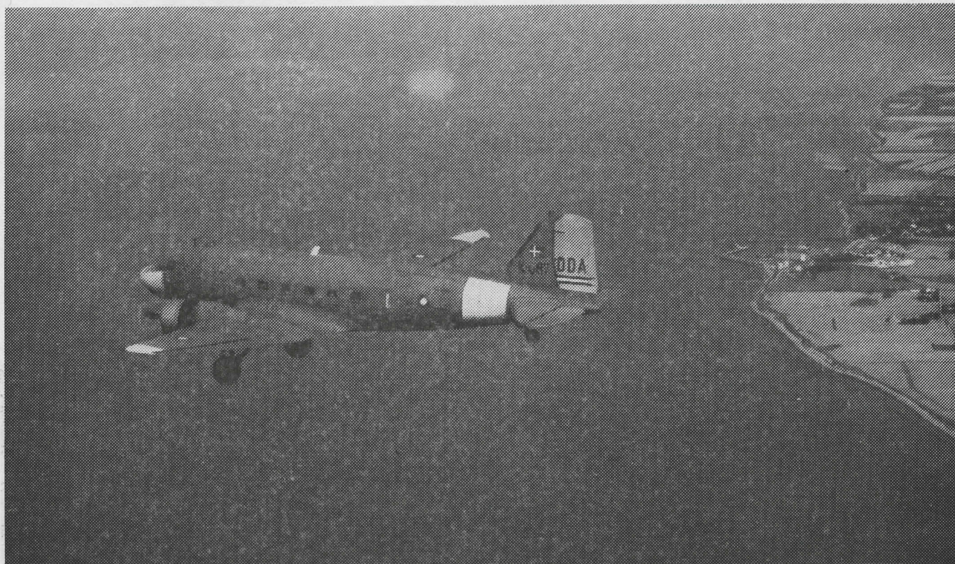
K-687 en route til Billund i 2.000 fods højde set fra en T-17. Bemærk det nedfældede understel samt de til færgeflyvningen lånte propeller, rorflader og motornaceller fra Danmarks Flyvemuseums anden C-47A, OY-DDA (ex K-681). I billedets højre kant ses Kolby Kås på Samsø. (foto: FLV)
