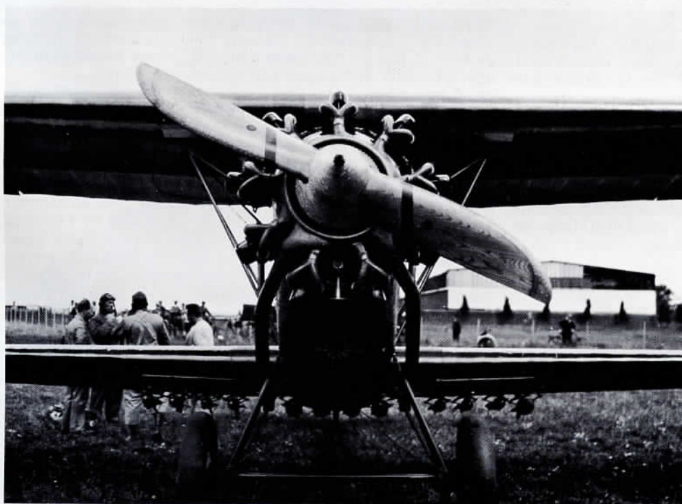
Astra propel på en Jupiterudstyret gammel I R. Lamineringen kan være svær at se, da der kun er anvendt een træsort. Bemærk metalkanterne, skråbåndene og de små runde mærker med stjernen. Læg endvidere mærke til de ophængte bomber af to forskellige størrelser under planer og krop.
