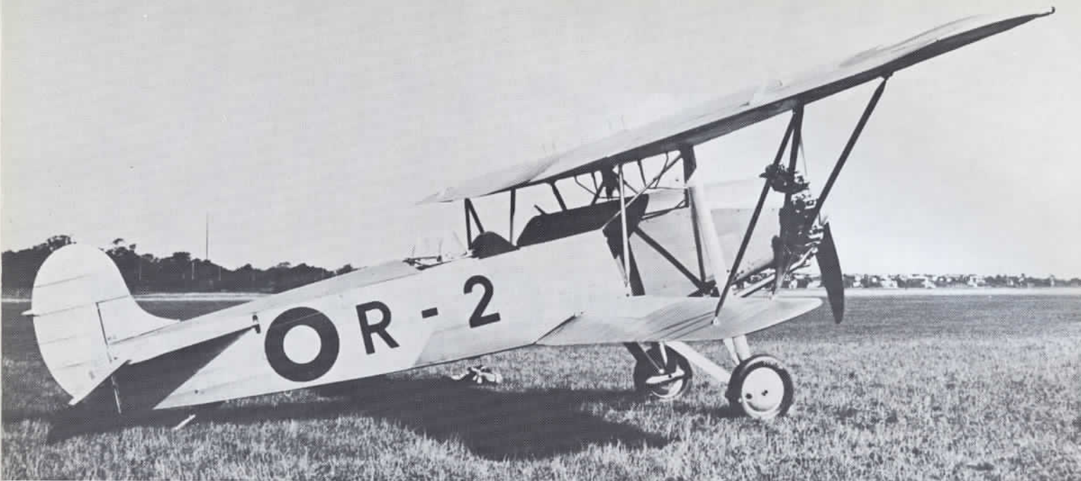
R-2 fotograferet den 3. september efter endt ombygning, der omfattede blandt andet nyt understel, generelt eftersyn, modifikation af installationer m.v. R-2 var prototype for denne ombygning, der omfattede alle de »gamle« I R, og det var normalt, at flyene havde E-vinger efter denne modernisering. Der er dog observeret B-vinger på R-maskiner helt frem til maj 1938 - altså længe efter at ombygningerne var gennemført, hvilket bekræftes gennem flere fotografier fra slutningen af trediverne.
