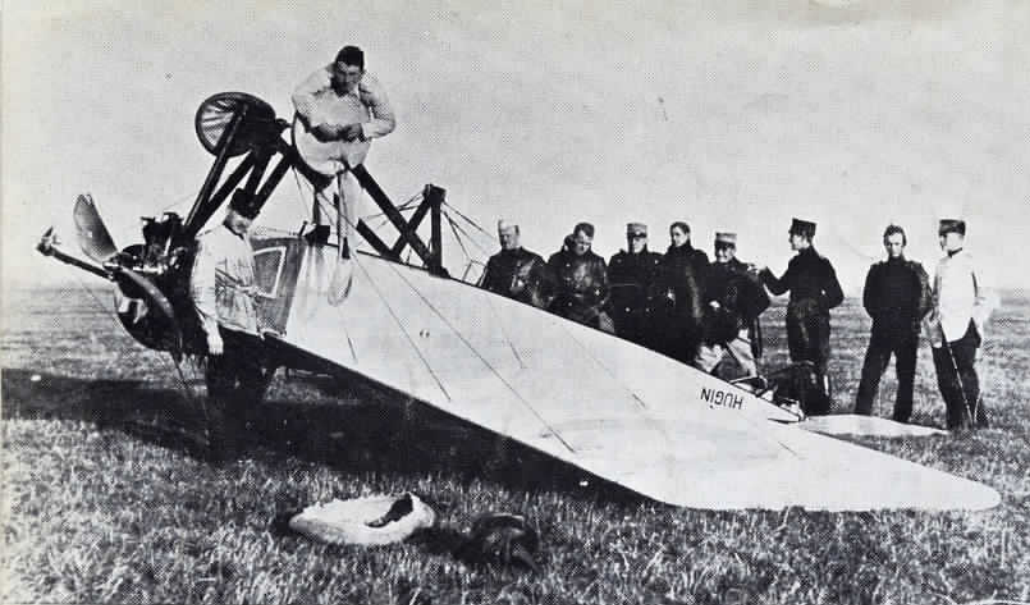
Morane Saulnier M.S. 1, HUGIN, med 50 HK roterende Gnôme motor bygget hos AB Enoch Thulins maskinværksted i Landskrona. Billedet er taget i forbindelse med Kofod-Jensens havari efter Jyllandsturen den 26. april 1916. HUGIN blev repareret, men totalhavarerede den 8. oktober 1919 på Kløvermarken.
